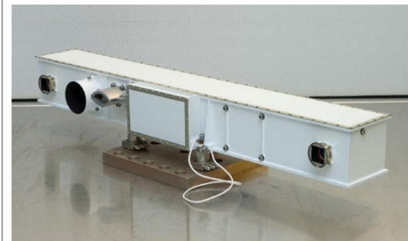
↑ A PanCam eszköz és a szűrőket tartalmazó kerék, M. de la Nougerede, UCL/MSSL
