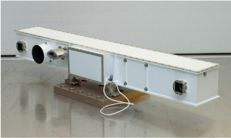
↑ A PanCam eszköz és a szűrőket tartalmazó kerék, M. de la Nougerede, UCL/MSSL
