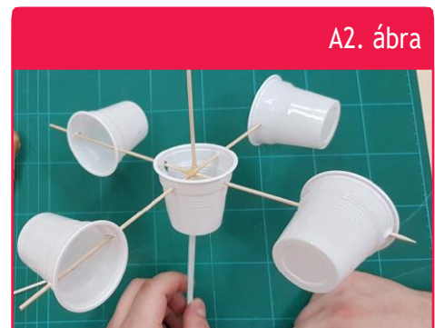
↑ Anemométer a szélsébség méréséhez.
